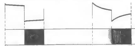
Bild 4. Oszillogramme eines Video-Verstärkers; links: exakter Schwarzweiß-Übergang bei einer Dachschräge von 2%, rechts: eine Dachschräge von 20% ergibt einen verwaschenen Übergang
